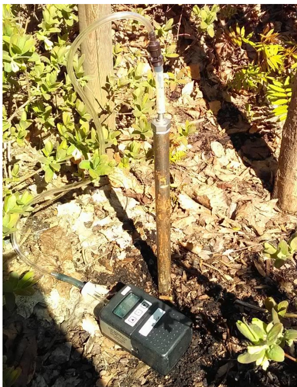
Figur 5.1 Installerad porluftsspets och pump för aktiv provtagning av porluft genom kolrör.
