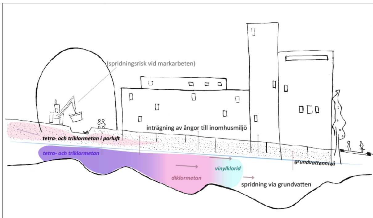
Figur 7.6 Uppdaterad konceptuell modell. Detekterad förorening och spridningsvägar, tvärsnitt syd till nord inom Gibraltarvallen
